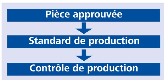
Au lieu de travailler avec des valeurs absolues de brillance, le contrôle qualité de la production de l'équipementier doit être basé sur la pièce approuvée et seules les différences sont mesurées avec le brillancemètre. Cette procédure élimine l'erreur de reproductibilité car la brillance est mesurée sur des types de matière et de surface relativement proches.
