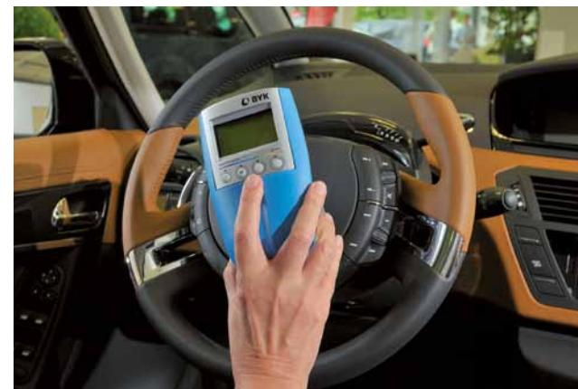
La nouvelle gamme des spectro-guides S offre des performances techniques améliorées pour le brillant à 60° dans la gamme des bas brillants 0 - 10 UB. Une excellente répétabilité de +/- 0,1 est garantie grâce à notre procédé de calibrage breveté.
