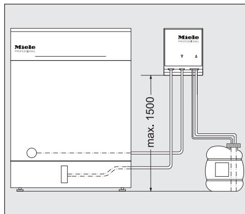
**⚠** Προβλήματα δοσομέτρησης εξαιτίας λάθος τοποθέτησης του δοχείου.
