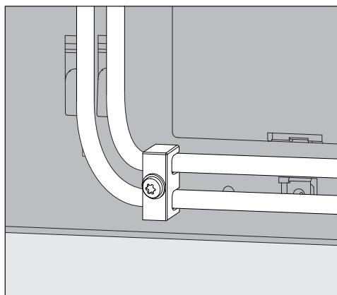
Držák dávkovacích hadic přiložený k DOS modulům se umísťuje vpravo dole na zadní straně mycího a dezinfekčního automatu a brání uvolnění hadic z dávkovacích hrdel.
