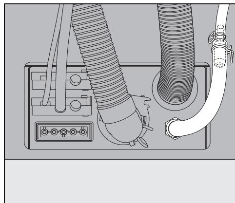
A tömlőcsatlakozó, a nagyobb átmérőjű adagolócsönökhoz való csatlakoztatáshoz a DOS-modul G 80-hoz van mellékelve, és a G 8066 és PG 8067 ipari mosogatógépeknél használni kell.
