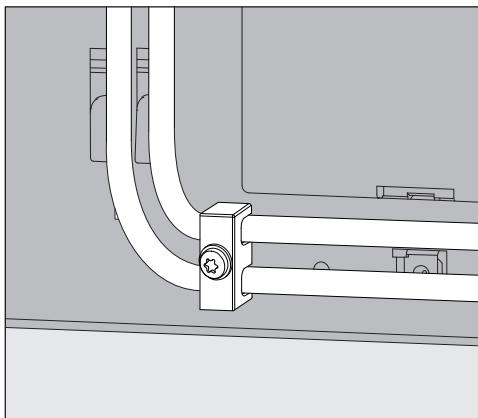
ホースが使用中にディスペンサー接続部から外れてしまうのを防ぐため、供給モジュールに付属している供給ホース用ストレインリリーフを機器裏面の右側底面に取り付けます。
