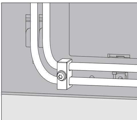
Το ανακουφιστικό καταπόνησης που υπάρχει στις μονάδες δοσολογίας για τους σωλήνες δοσομέτρησης τοποθετείται στην κάτω δεξιά πίσω πλευρά της συσκευής καθαρισμού και εμποδίζει το χαλάρωμα των σωλήνων από τα στόμια δοσομέτρησης.
