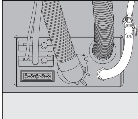
より大きな直径のディスペンサーと接続するためのホースアダプターは、DOS G 80に付属しており、G 8066およびPG 8067業務用食器洗い機と接続する場合は必ず使用してください。
