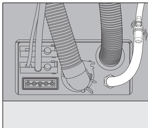
Adapter za crijevo, za priključivanje nastavka za doziranje velikog promjera, priložen je uz DOS modul G 80 i mora se upotrebljavati s profesionalnim perilicama G 8066 i PG 8067.
