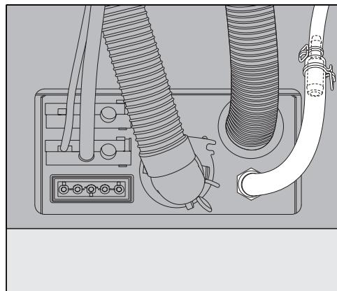
Ο αντάπτορας σωλήνα για τη σύνδεση σε στόμιο δοσομέτρησης με μεγαλύτερη διάμετρο, εσωκλείεται στη μονάδα δοσολογίας G 80 και πρέπει να χρησιμοποιηθεί στα επαγγελματικά πλυντήρια πιάτων G 8066 και PG 8067.
