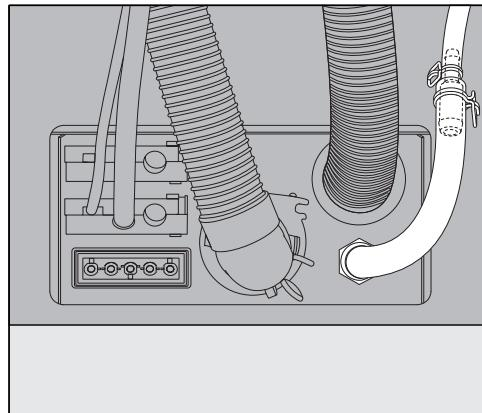
Der Schlauchadapter, zum Anschluss an den Dosierstutzen mit größerem Durchmesser, liegt dem DOS-Modul G 80 bei und muss bei den Gewerbegeschirrspüler G 8066 und PG 8067 verwendet werden.
