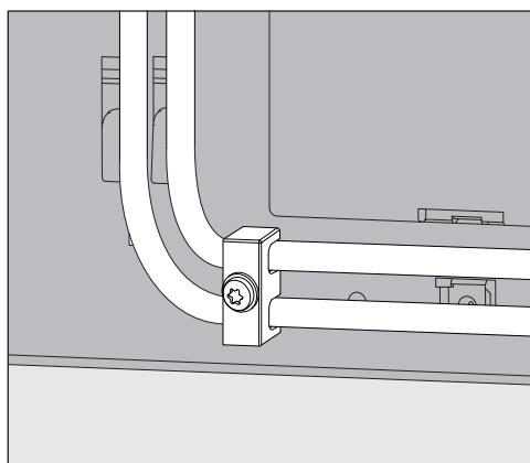
Un passe-câbles joint pour les tuyaux de dosage est fixé aux modules DOS en bas à droite à l'arrière du laveur-désinfecteur et évite aux tuyaux des raccords de dosage de se détacher.
