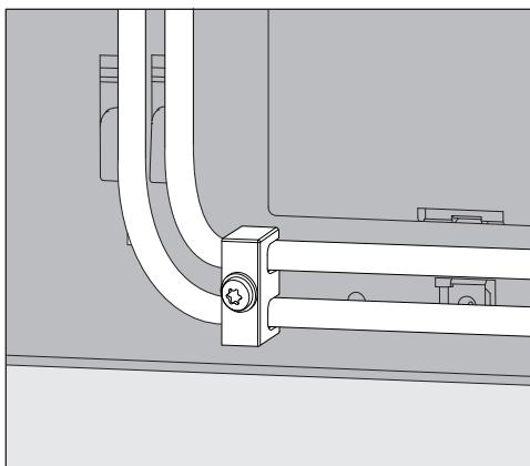
Die den DOS-Modulen beilegende Zugentlastung für die Dosierschläuche wird rechts unten auf der Rückseite des Reinigungsautomaten angebracht und verhindert ein Lösen der Schläuche von den Dosierstutzen.
