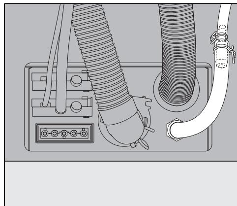
Der følger en slangeadapter til tilslutning til doseringsstudserne med større diameter med DOS-modul G 80. Denne skal anvendes ved tilslutning til de professionelle opvaskemaskiner G 8066 og PG 8067.
