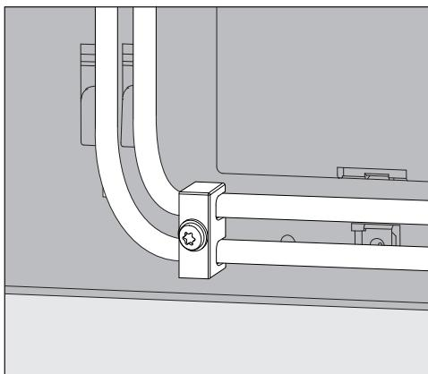
El prensacables que se adjunta con los módulos DOS para mangas de dosificación se ha colocado abajo a la derecha en la parte posterior de la lavadora desinfectadora y evita que las mangas se suelten de los manguitos de dosificación.
