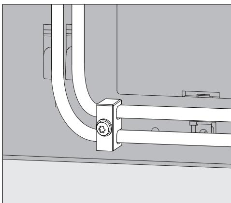
DOS modulima priloženo vlačno rasterećenje dozirnog crijeva postavlja se desno dolje na stražnju stranu uređaja za pranje i sprječava oslobađanje crijeva iz dozirnog nastavka.
