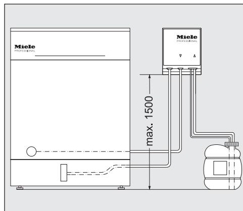
**⚠ Problèmes de dosage en raison d'une mauvaise installation du bidon.**
