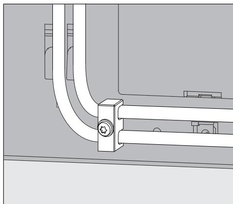
Il fermacavo in dotazione con i moduli DOS per i tubi di dosaggio viene fissato in basso a destra sul lato posteriore della macchina speciale per il lavaggio ed evita che si stacchino i tubi dai manicotti.
