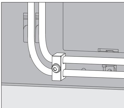
Den medfølgende trækaflastning til doseringsslangerne anbringes nederst til højre på bagsiden af opvaske-/rengeøringsmaskinen; den forhindrer, at slangerne løsner sig fra doseringsstudserne.
