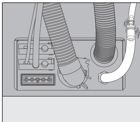
L'adattatore del tubo per l'attacco al bocchettone di dosaggio con un diametro più grande è in dotazione con il modulo DOS G 80 e deve essere impiegato con le lavastoviglie industriali G 8066 e PG 8067.
