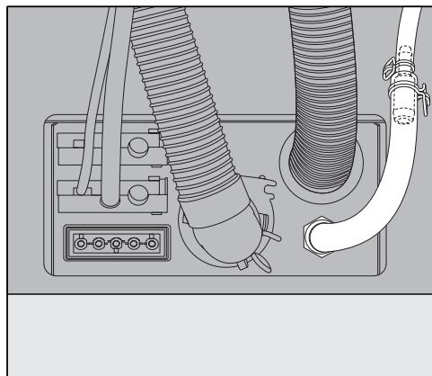
L'adaptateur de flexible, pour le raccordement au raccord de dosage d'un diamètre plus grand, est joint au module DOS G 80 et doit être utilisé pour les lave-vaisselle professionnels G 8066 et PG 8067.
