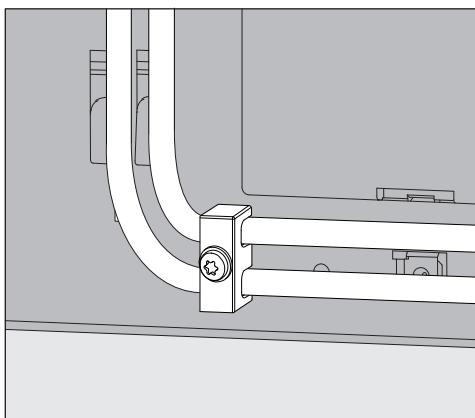
A DOS-modulokhoz mellékelt feszültségmentesítő az adagolótömlőkhöz a tisztító automata hátoldalán jobbra lent van felszerelve, és megakadályozza a tömlők lecsúszását az adagolócsomkról.
