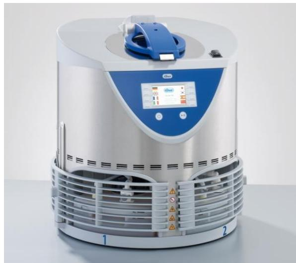
Elmasolvex® VA est une machine de nettoyage entièrement automatique destinée au nettoyage des pièces de précision mécaniques. Il s'agit principalement de petites pièces de montres (roues, balanciers, ressorts ou boîtiers) telles qu'elles sont produites dans l'industrie horlogère.
