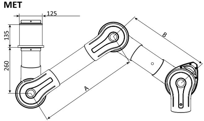
MET pour montage au plafond, sans console de fixation au plafond MTI.
