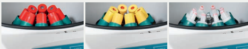
Rotor angulaire représenté avec différents tubes de prélèvement sanguin
