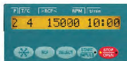
Panneau de commande de la MIKRO 200 R réfrigérée (Panneau N-Plus)
