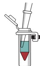
De par la centrifugation dans le rotor libre, le culot s'amasse dans la pointe du microtube et peut être ainsi plus facilement traité ou analysé.
