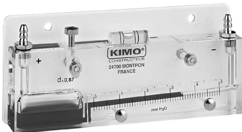
Les manomètres à colonne de liquide inclinée de la gamme HP, développés et fabriqués par KIMO, sont destinés aux mesures de faibles variations de pression, dépression, pression différentielle de l'air ou du gaz. Ces appareils sont particulièrement recommandés pour les mesures de surpression des salles blanches, des blocs opératoires, laboratoires, locaux stériles, flux laminaires...
