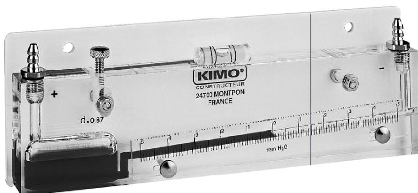
Les manomètres à colonne de liquide inclinée de la gamme TX, développés et fabriqués par KIMO, sont destinés aux mesures de faibles variations de pression, dépression, pression différentielle. Ces appareils sont particulièrement recommandés pour les mesures de surpression et dépression des salles blanches, des blocs opératoires, laboratoires, locaux stériles, flux laminaires...
