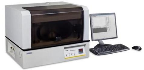
Le VAC-V1 est utilis é pour tester la perm éabilit é aux gaz, par la m éthode de diff érence de pression. Il permet de d éterminer le taux de transmission le coefficient de solubilit é le coefficient de diffusion et le coefficient de perm éabilit é Il permet de tester les films plastique, les films composites , les mat ériaux à propri ét é barri ère élev ée, les feuilles m étalliques, les caoutchoucs et les membranes perm éables.
