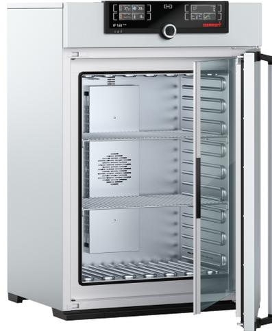
Le chauffage de cet incubateur est adapté aussi bien à la convection naturelle qu'au brassage d'air forcé, c'est pourquoi il est possible d'éteindre complètement le ventilateur et de réchauffer de manière particulièrement douce les éléments de chargement précieux dans le cadre de travaux dans le domaine de la recherche, de la pharmacie, de la médecine et de la chimie alimentaire.
