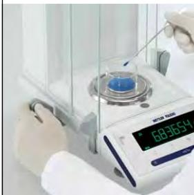
Réduction du nombre de gestes nécessaires pour chaque opération de pesage. Il vous suffit d'ouvrir le pare-brise ErgoDoor d'une main et de placer simultanément l'échantillon de pesage avec l'autre main.
