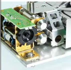
La technologie METTLER TOLEDO HRT (HiRes Technology) comprend deux poids intégrés. Associée à la technologie de calibrage totalement automatique FACT (Fully Automatic Calibration Technology), elle permet à la balance de réaliser automatiquement les opérations de calibrage et de linéarisation.
