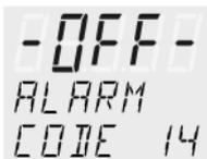
Cette sécurité haute de température est indépendante du circuit de régulation. Lorsqu'elle se déclenche, la pompe et le chauffage sont coupés.
