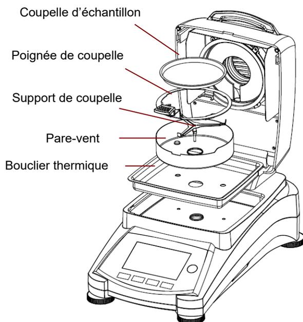
Ouvrir le capot et retirer le support de coupelle, la coupelle d'échantillon, le pare-vent et le bouclier thermique de l'appareil avant de le nettoyer.
