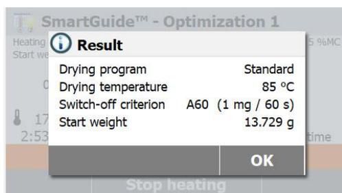
Lorsque le processus d'optimisation est terminé, le SmartGuide™ fournira une méthode de séchage optimisée incluant un programme de séchage, une température de séchage et un critère de désactivation dans le résultat.
