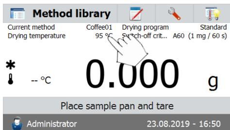
Une méthode par défaut est préinstallée sur l'analyseur avant sa livraison. Les paramètres de la méthode par défaut sont affichés à l'écran. Pour modifier les paramètres, appuyer sur la zone où les paramètres sont affichés comme cela est illustré à gauche.
