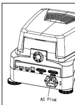
Brancher le cordon d'alimentation à la prise située à l'arrière de l'analyseur d'humidité et à la prise du secteur. L'analyseur d'humidité est opérationnel dès qu'il est mis sous tension. L'écran d'affichage reste éteint jusqu'à ce que le bouton Allumer/Éteindre soit appuyé.
