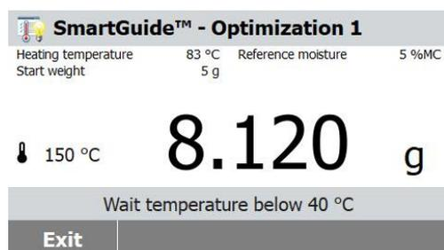
**Remarque:** L'analyseur d'humidité doit refroidir si la température de la chambre de chauffage est supérieure à 40 ° C.
