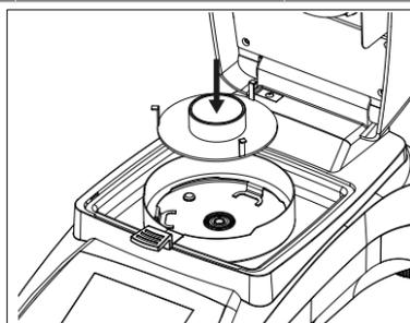
Appuyer sur **Démarrer** pour commencer la procédure d'étalonnage de la température. Suivre les invites de commande à l'écran tout au long de la procédure.
