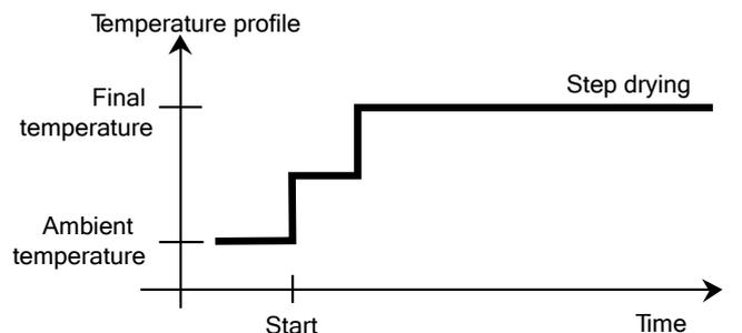
Une possibilité d'utilisation alternative réside dans la détermination sélective de l'humidité à des températures différentes. Le gypse, par exemple, ne libère son eau de surface qu'à 50 °C, tandis que l'eau de cristallisation ne peut être séparée avant 168 °C. Avec ce programme de dessiccation, il devient ainsi possible de déterminer l'eau de surface et l'eau de cristallisation séparément lors de la même analyse avec un profil de température contrôlée.
