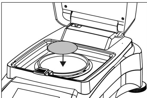
Placer la coupelle d'échantillon vide et le tampon en fibre de verre dans le porte-coupelle. La coupelle d'échantillon doit être à plat dans le porte-coupelle.
