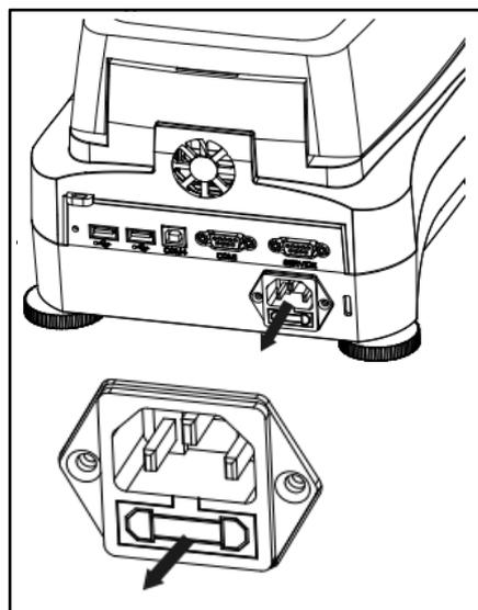
À l'aide d'un stylo-test, tourner le porte-fusible vers la gauche (sens antihoraire) et retirer le fusible.
