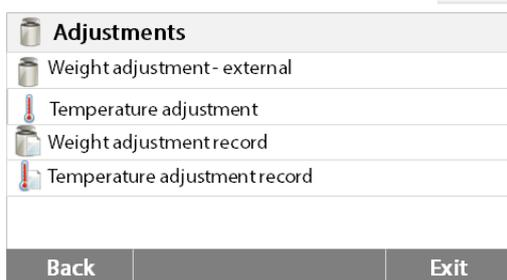
Appuyer sur le bouton Étalonnage du Poids et de la température pour avoir accès au menu d'étalonnage.
