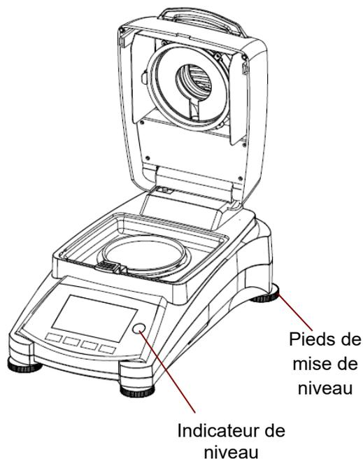
Régler les pieds de mise de niveau de l'analyseur d'humidité jusqu'à ce que la bulle d'air dans l'indicateur soit centrée. L'indicateur de niveau se trouve sous le capot vers l'arrière de l'analyseur d'humidité.
