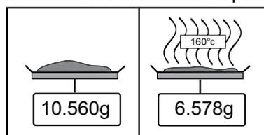
L'analyseur d'humidité Ohaus est composé de deux outils : une balance de précision et une unité de dessiccation. Contrairement à d'autres méthodes thermogravimétriques (étuve, infra-rouge, micro-ondes), l'analyseur d'humidité à chauffage halogène fonctionne avec une unité de dessiccation équipée d'un halogène. Ceci assure un chauffage rapide de l'échantillon et garantit ainsi une disponibilité rapide des résultats d'analyse.
