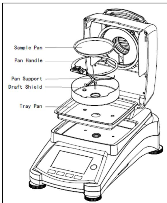
Lever le capot vers le haut et installer la plaque de tôle dans la base de la cuve de chauffage.
