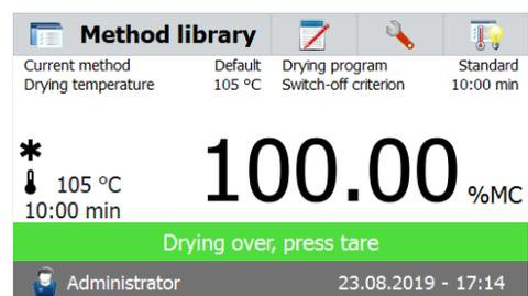
L'affichage indique le nom de la méthode, la température / l'heure, le poids initial, la température réelle, le durée écoulé de l'essai, l'humidité et la courbe. Le test arrête automatiquement à la fin de l'analyse.
