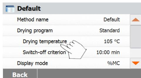
Appuyer sur les éléments de paramétrage pour les modifier.
