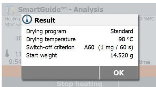
Quand l'analyse est terminée, le **SmartGuide™** vous proposera une méthode incluant le programme de séchage, la température de séchage, et les critères de désactivation.
