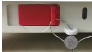
Bloccato con Sigillo di Cavo
