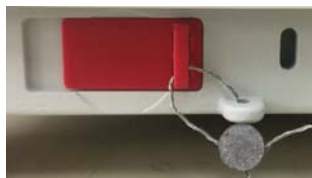
Verrouiller avec le joint de fil
