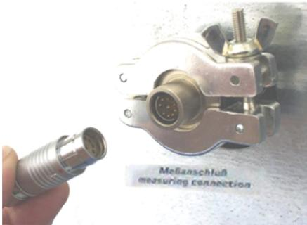
Figure 24: Connexion de mesure (17) avec passage de mesure
