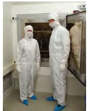
Four à convection forcée N 250/65 HAC avec chambre en exécution sans particules. La porte du four se trouve dans la chambre blanche pour le chargement, classe 100, chambre du four dans la chambre grise située derrière.
