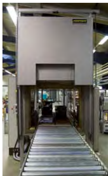
N 1680/45 AS avec transfert à rouleaux, intégré dans une ligne de production
