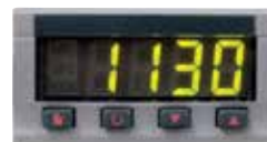
Régulateur de sécurité de surchauffe
