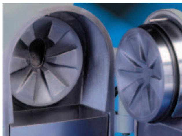
*Vue du compartiment de broyage du DM 200 (disques de broyage avec disposition progressive de la denture)*
