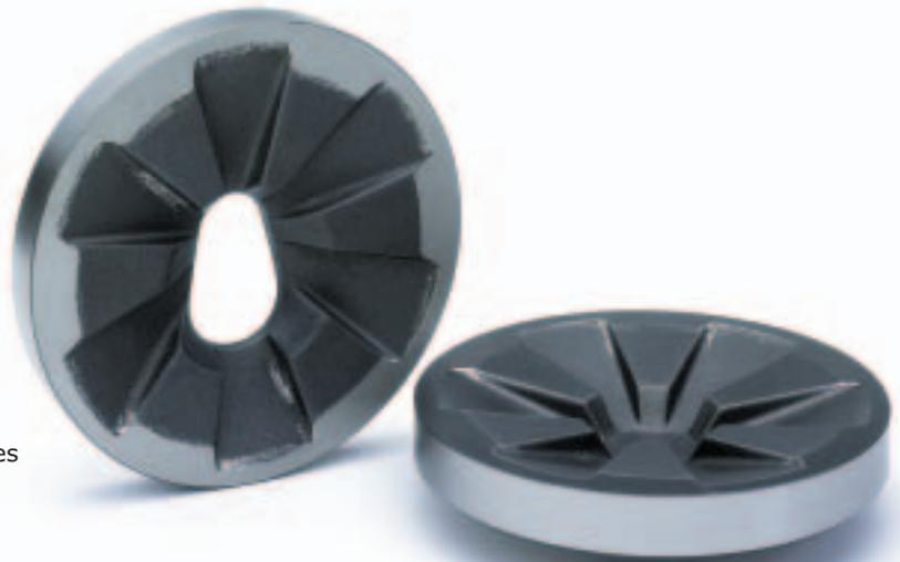
Les disques de broyage présentent après une longue utilisation une usure naturelle. Cependant avant de les remplacer par de nouveaux disques on peut utiliser le côté opposé de la denture en changeant la direction de rotation du moteur. On peut ainsi prolonger la durée de vie des disques d'une façon considérable.
