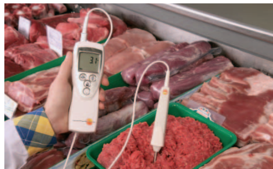
Contrôle de la température dans un comptoir réfrigéré
