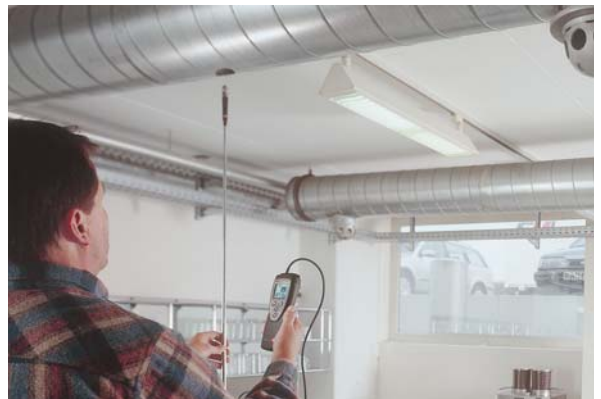
testo 416, par ex. pour des mesures de débit d'air en apport d'air neuf dans une cuisine
