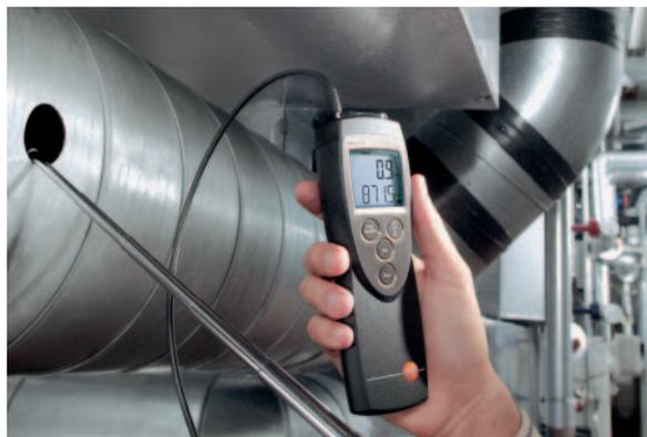
testo 425, par exemple pour la détermination du débit d'air en extraction
