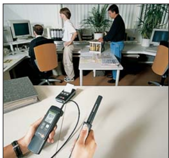
Surveillance de la qualité de l'air ambiant et impression rapide des résultats de mesure avec l'imprimante
