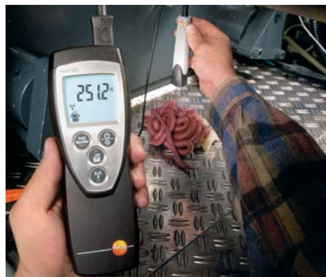
Sonde de pénétration très rapide adaptée aux mesures dans le matériau, les produits alimentaires...
